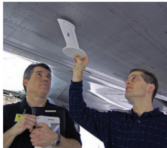
Técnicos da Aircell e da Boeing conferem a instalação do dispositivo externo para o uso da internet em um Boeing 737-700.
