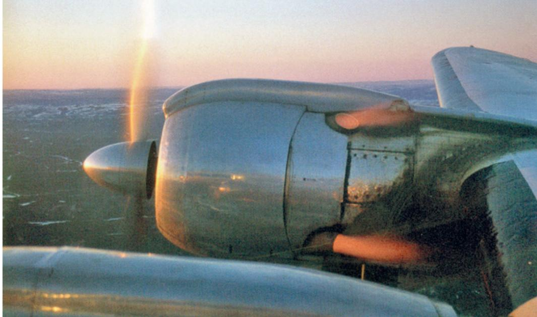
A descarga dos motores Turbo Compound apresentava um rastro de fogo após as turbinas de recuperação de potência, que assustava passageiros desavisados.
