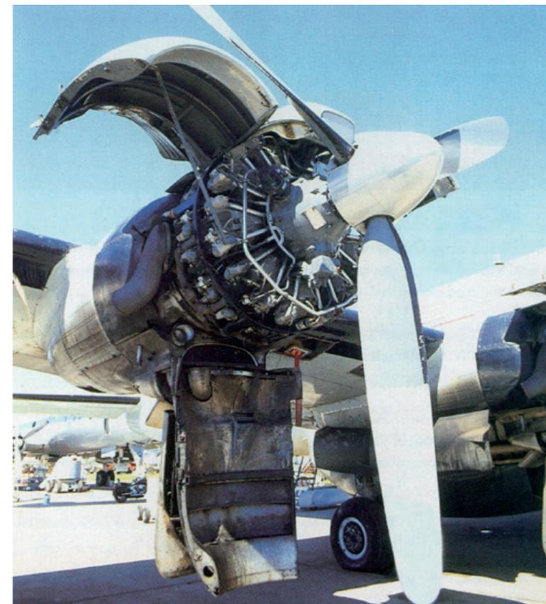
Um motor Turbo Compound com as carenagens abertas para inspeção, vendo-se um tubo de descarga com a capa da turbina de recuperação de potência.
