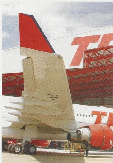
Acima, o conjunto de leme vertical, profundores e APU. À direita, turbina GE CF6-80E, de 72.000 libras de empuxo; à esquerda, vista inferior da asa, com *winglet* na ponta de asa e *aileron* em primeiro plano
