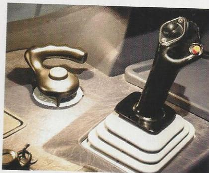
O sidestick adotado pela Airbus (ao lado) pode exigir um tempo de adaptação mas melhora a precisão da pilotagem. Abaixo, o moderno *flight deck* com as telas E/WD e SD no centro do painel e telas PFD e ND nos cantos direito e esquerdo. No pedestal central, três FMS
