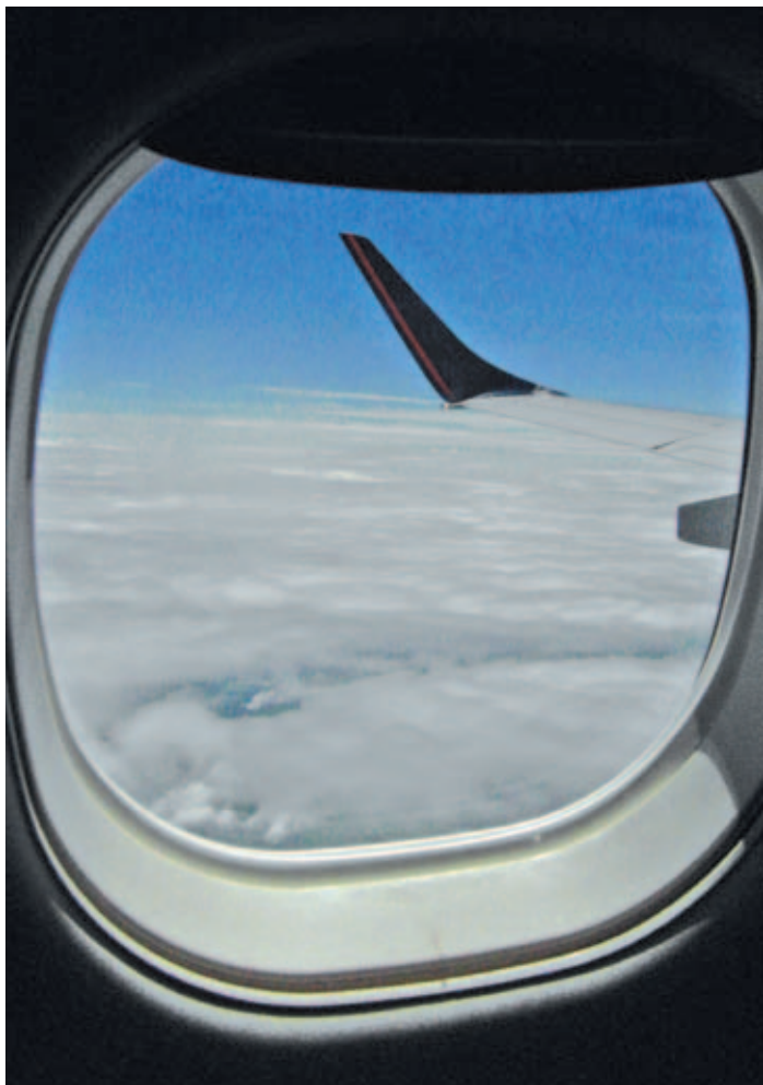
O emprego de winglets diminui o arrasto e aumenta o alcance (ou carga paga) dos E-Jets.
